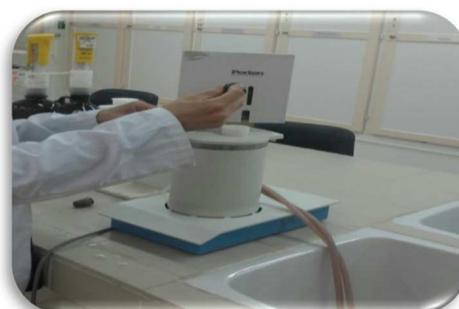
Détermination du temps de chute Hagberg des céréales et dérivés
