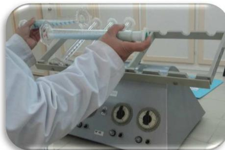
Détermination de l'indice de Zéleny des blés et farines
