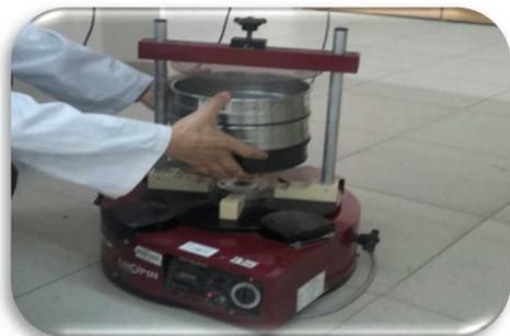
Détermination de la granulométrie des farines et semoules.
