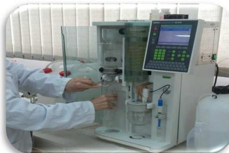
Détermination de la teneur en protéines des céréales et dérivés (Kjeldahl)
