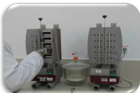
Détermination de la teneur en eau des céréales et dérivés
